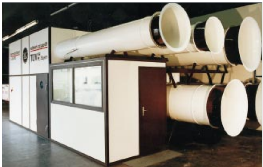
AL-KO THERM werkseigener TÜV-geprüfter Luftmeß-Prüfstand für Raumluftechnische Geräte (i. A. DIN 24 163) AL-KO-THERM's own TÜV-approved air measurement test bed for ventilation and air-conditioning equipment
